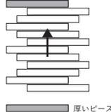
シートには方向性があります。シートの一番上に厚みが厚いピースが来る方向を上とします。25×202角ネット張りを施工する際は、上図のように隣り合うエコカラットプラスの向きがそろわないように交互に並べて施工してください。
