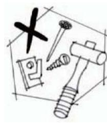
直接打ち込みますと、割れなど破損の原因になります。フックやビスの取付けには、電動ドライバーをご使用ください。
