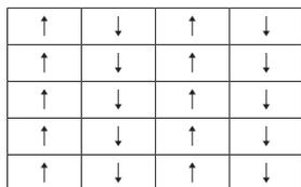
606×303角平 (レリーフ) を施工する際は、上図のように上向きと下向きの列が交互に並ぶように施工してください。
