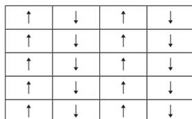
303×151角平 (レリーフ) を施工する際は、上図のように上向きと下向きの列が交互に並ぶように施工してください。
